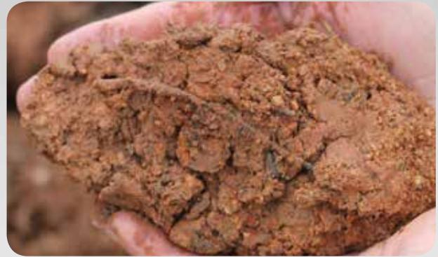
apisonadores vibratorios o rodillos pata de cabra para obtener una compactación adecuada. Las partículas de arcilla (suelos cohesivos), en realidad están compuestas por pequeñas plaquetas “tipo panqueque” que se superponen en capas. Los espacios entre ellas pueden llenarse con aire o con agua. La unión molecular entre las placas las mantiene en su lugar.
